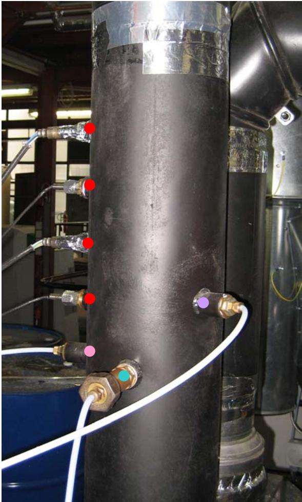
Bild 4-3 Messstrecke beim Kachelofen-Heizeinsatz
