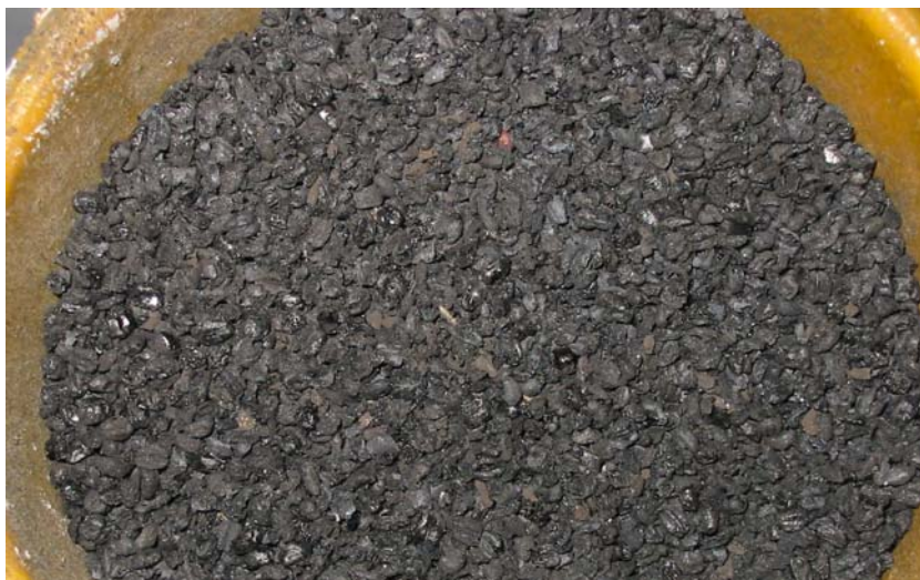
Bild 4.3 Verbrennungsrückstand aus dem Ascheaustrag bei Versuchen mit Getreidekörnern beim Heizkessel Agro 40
