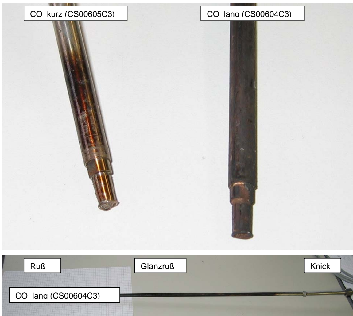
Bild 17: Die beiden Sonden CO_kurz (CS00605C3, links) und CO_lang (CS00604C3; rechts und unten) nach Ihrem Ausbau zu einer Zwischencharakterisierung am 22.07.2007.
