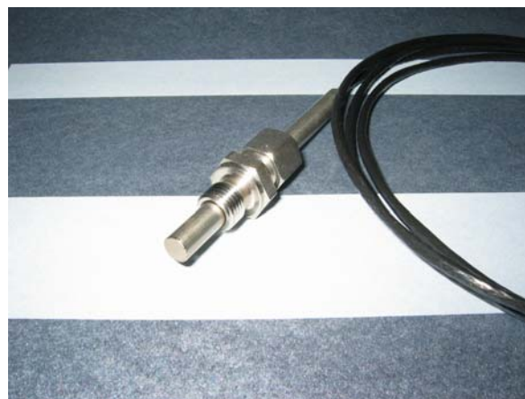
d) Optimierter Prototyp mit Filtersieb (ab ca. Mai 2008; nach Projektende)
