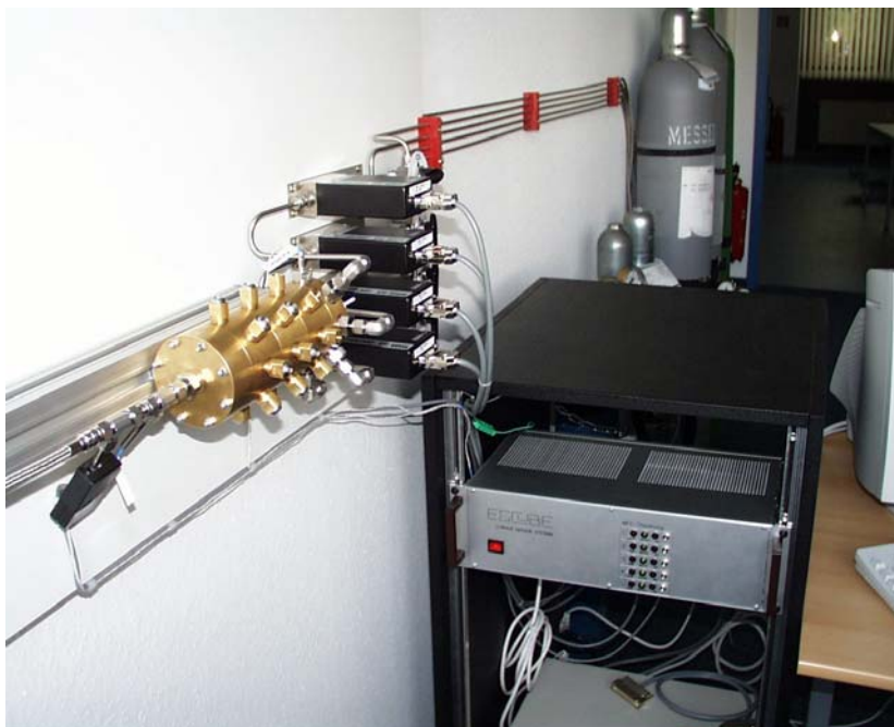
Bild 8: Schematische Darstellung (oben) und Ansicht auf den ESCUBE Gasmessstand (unten).
