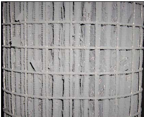
Bild 5.11: Oberfläche der Filterpatrone nach den Verbrennungsversuchen mit Gerste und Zuschlagsstoff Branntkalk
