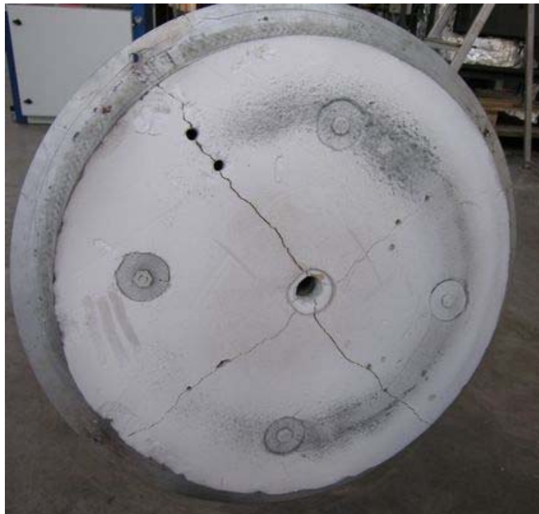
Bild 3: Deckel des Agroflam-40 mit Bohrungen für Temperatur- und CarboSen-Sonden. Die Risse sind durch Thermospannungen verursacht [8].
