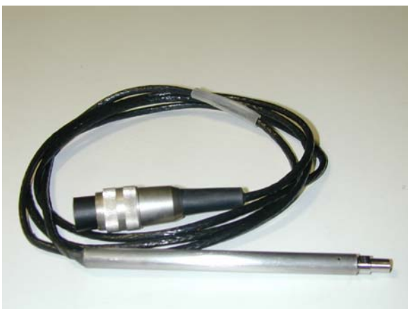
c) Fortgeschrittener Prototyp mit abschraubbarer Frontkappe/Sinterfilter (ab ca. Jun. 2006)
