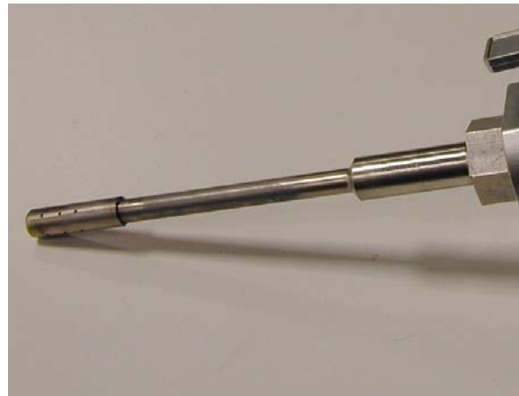
b) Erster Prototyp mit festem Sinterfilter (ab ca. Feb. 05)
