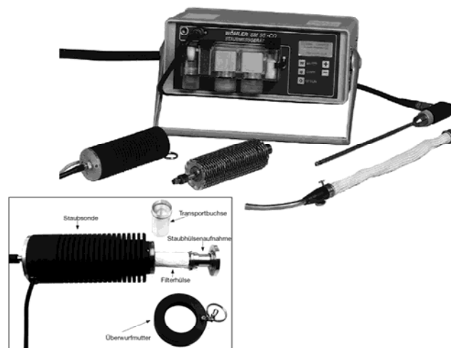
Abbildung 5 Messgerät der Fa. Wöhler für Überwachungsmessungen im Rahmen der 1. BImSchV
