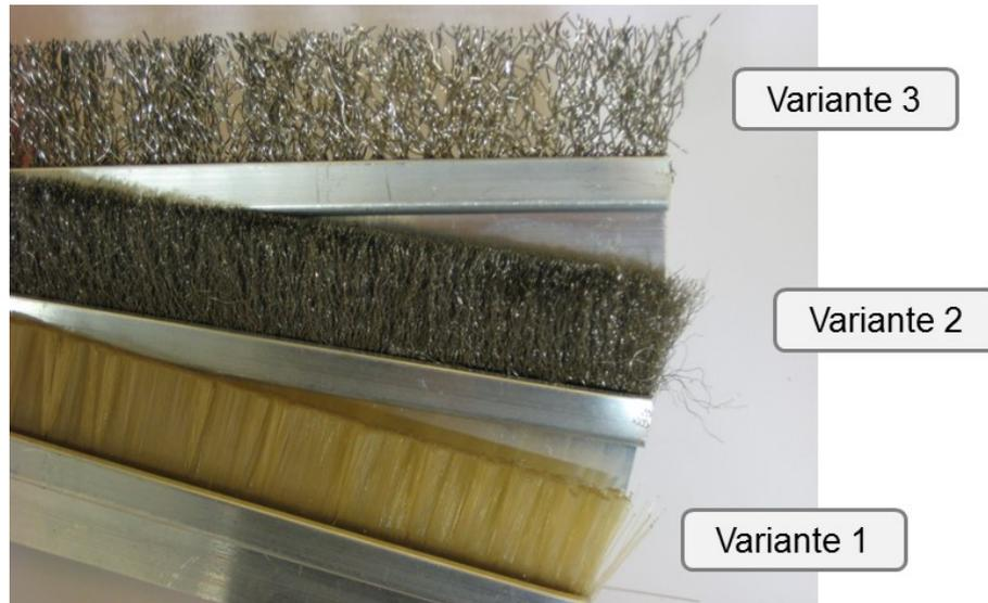
**Abbildung 4.5** Abreinigung mit Leistenbürsten - Auswahl von 3 Varianten
