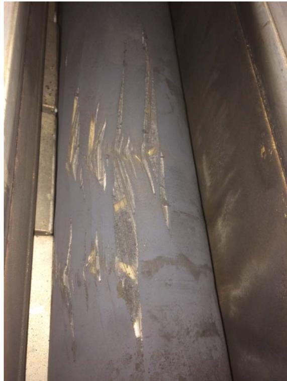
**Abbildung 5.12 Filterzustand nach Testlauf mit Absaugdüsen - Filtergewebe ist aufgefaltet und eingerissen aufgrund zu starker Anpressung der Düsen, Ansicht von oben**
