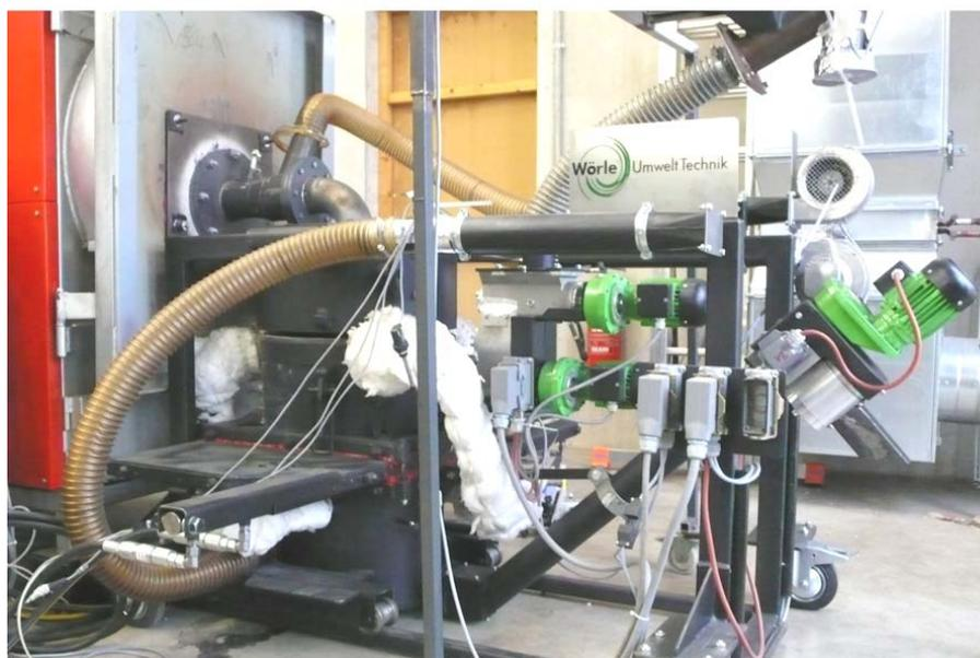
**Abbildung 16** Prototyp der Firma Wörle an einem Heizkessel im IFK-Technikum
