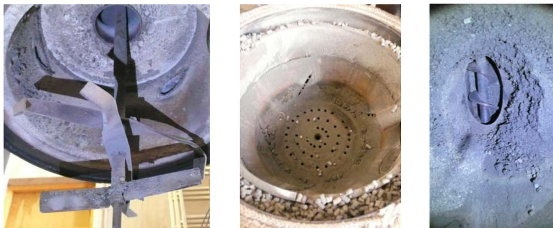
**Abbildung 26** links: Kreuzbalkenrührer mit Ascheschieber
