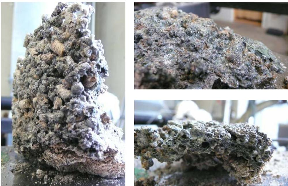
**Abbildung 23 Verschlackungen bei Verbrennungsversuche mit Heupellets**
