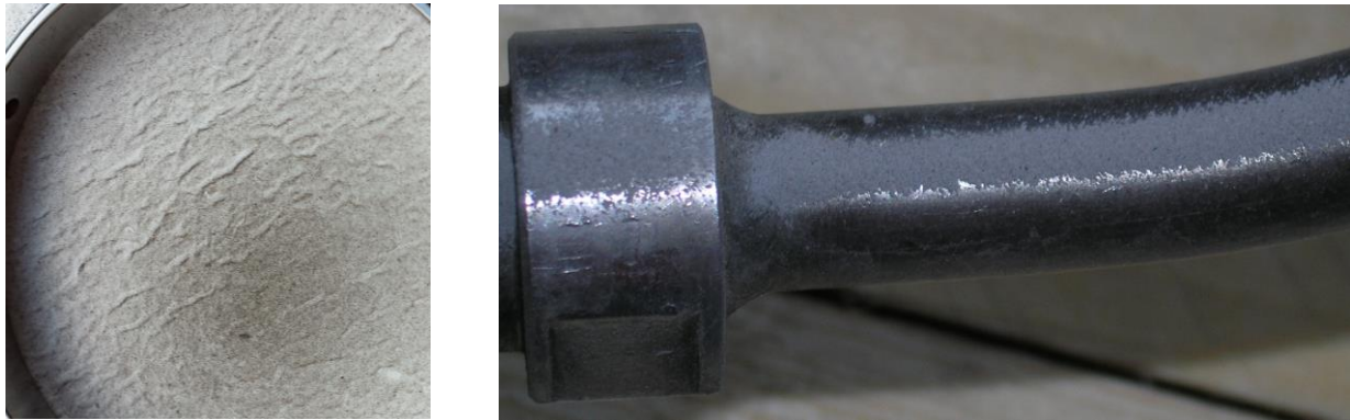
Abbildung 5.13 Feldmessungen Anlage 1- Referenzmessverfahren: auf Planfilter abgeschiedene Stäube (links) und Staubablagerungen auf Entnahmesonde (rechts)
