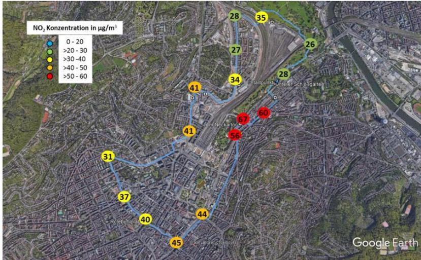
Abbildung 16: Ergebnisse der NO<sub>2</sub>-Passivsammlermessungen für die IOP3 (21.01.2018 bis 18.03.2018)
