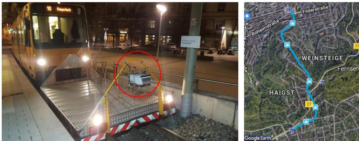
Abbildung 25: Messaufbau für die Zahnradbahn-Messungen mit den Low-Cost-Partikelsensoren (links) und Route der Zahnradbahn und Umgebung auf einem Satellitenbild (rechts)
