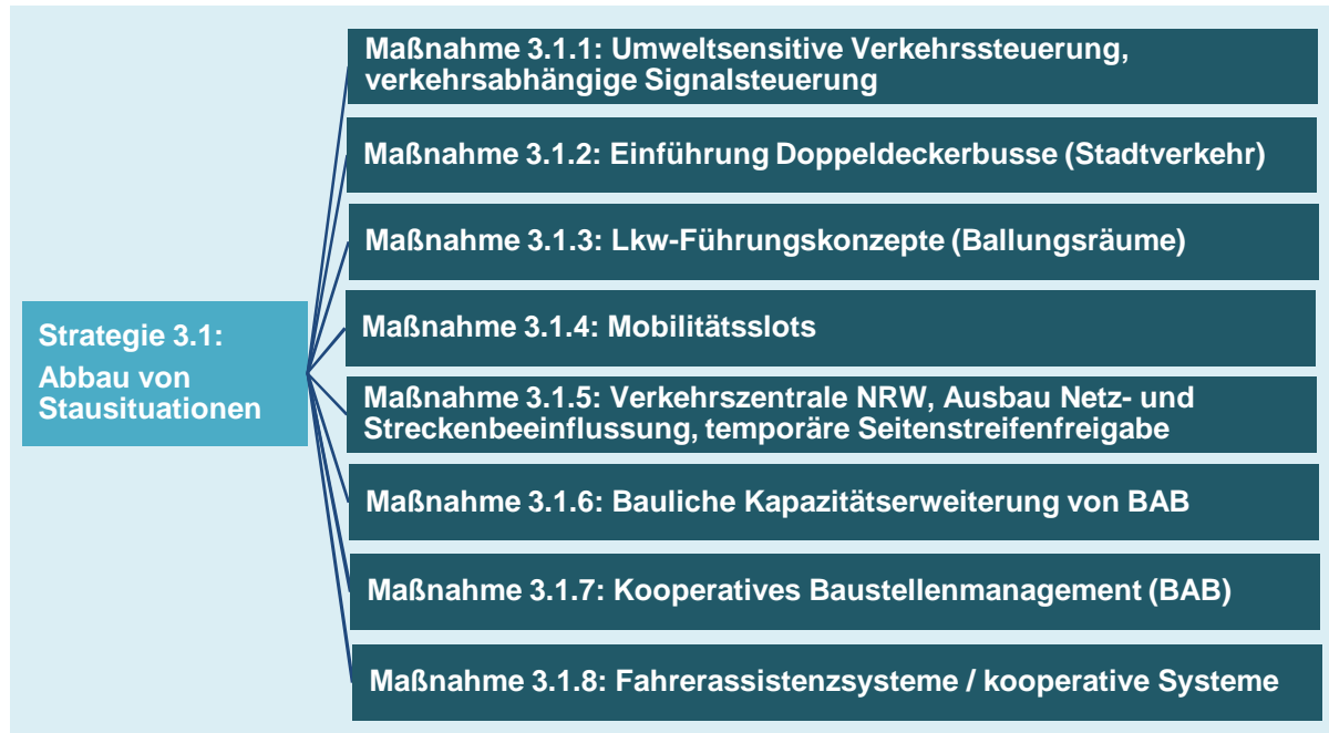
Bild 5.42: Maßnahmen zur Umsetzung der Strategie „Abbau von Stausituationen“
