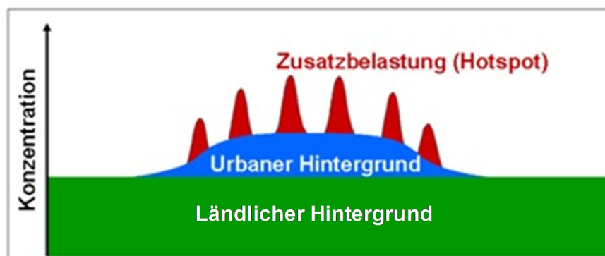
Bild 3.21: Schema der Zusammensetzung der städtischen Gesamtbelastung nach /Lenschow et al. 2001/; Bildquelle: nach /UBA 2011a/
