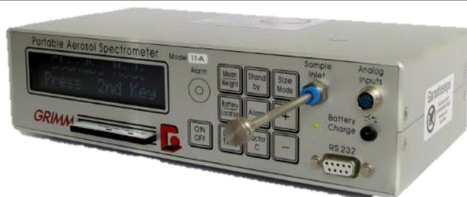
**Abb. 3.17:** Tragbares Laser-Aerosol-Spektrometer [23]
