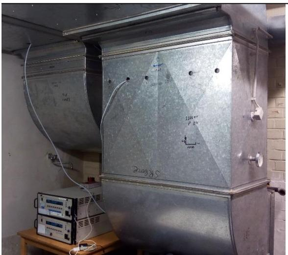
**Abb. 3.9:** Aufbau der Chemilumineszenz-Geräte am Belüftungssystem
