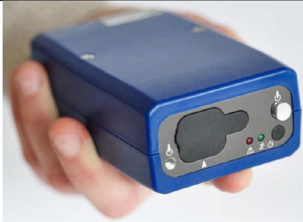
**Abb. 3.21:** Tragbares Rußmessgerät AE51, Fa. Aethlabs [25]
