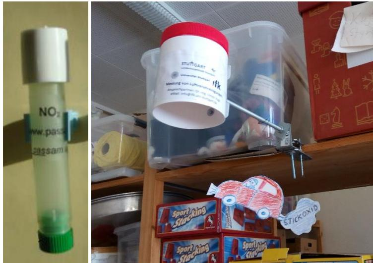
**Abb. 1:** Links: NO<sub>2</sub>-Passivsammlerröhrchen. Rechts: Abdeckung
