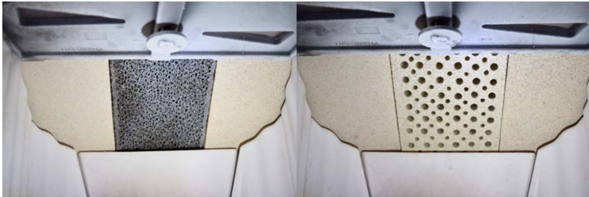
Abbildung 2.45 Kaminofen Hark 44 GT ECOplus: Ansicht des oberen Bereichs des Feuerraums mit integriertem Linder-Katalysator aus katalytisch beschichteter Schaumkeramik (links) und Dummy aus Vermiculite-Platten (rechts)
