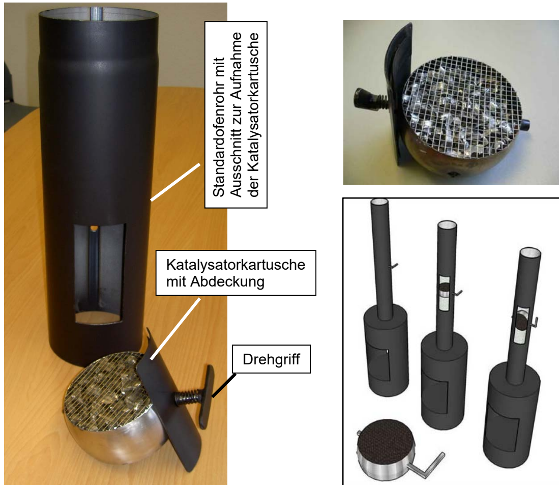
Abbildung 2.54 Katalysator der Fa. moreCat GmbH: Katalysatorlinse mit Ofenrohr (links), befüllte Katalysatorlinse (Rechts oben) und Einbau des Katalysatorsystems (rechts unten) (Struschka, 2008 (2))
