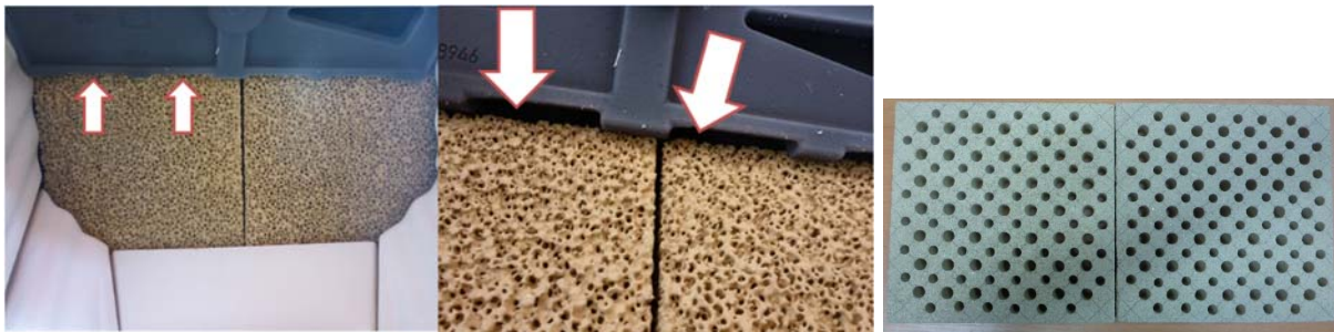
Abbildung 2.43 Kaminofen Hark 44 GT ECOplus: Ansicht der Schaumkeramik im oberen Bereich des Feuerraumes mit markierten Spalten (Bypässe für Verbrennungsgas) (links) und Dummy aus Vermiculite-Platten (rechts)
