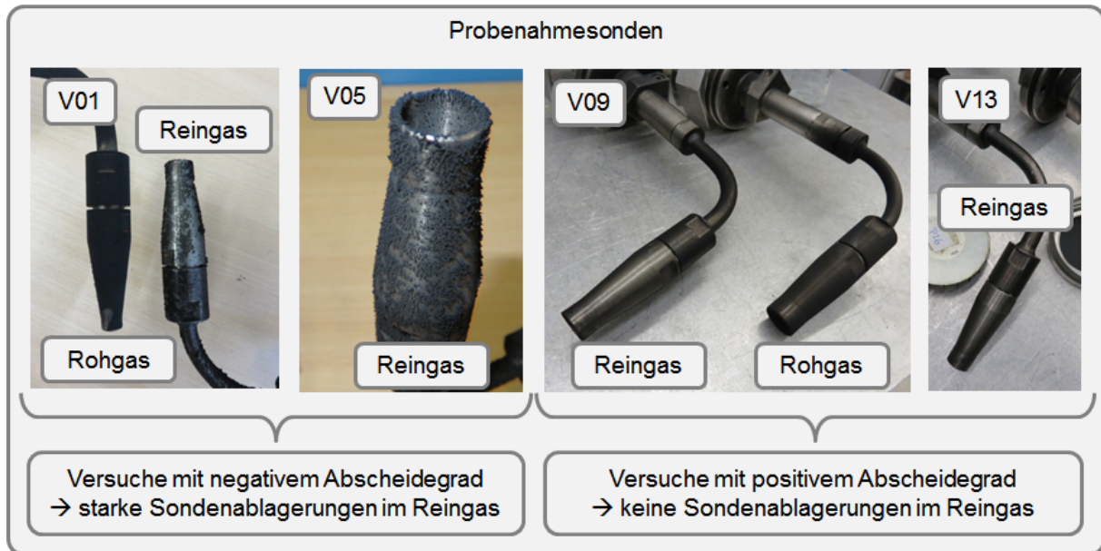
Abbildung 3.22 Abhängigkeit der Ablagerungen an der Staubprobennahmesonde vom Abscheidegrad. Beispiele für Sonden mit und ohne agglomerierte Ablagerungen
