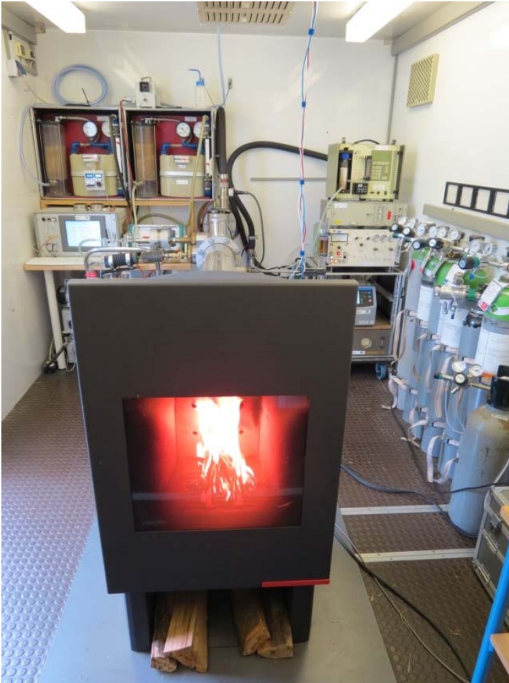
Abbildung 2: Innenansicht des Holzofenprüfstandes
