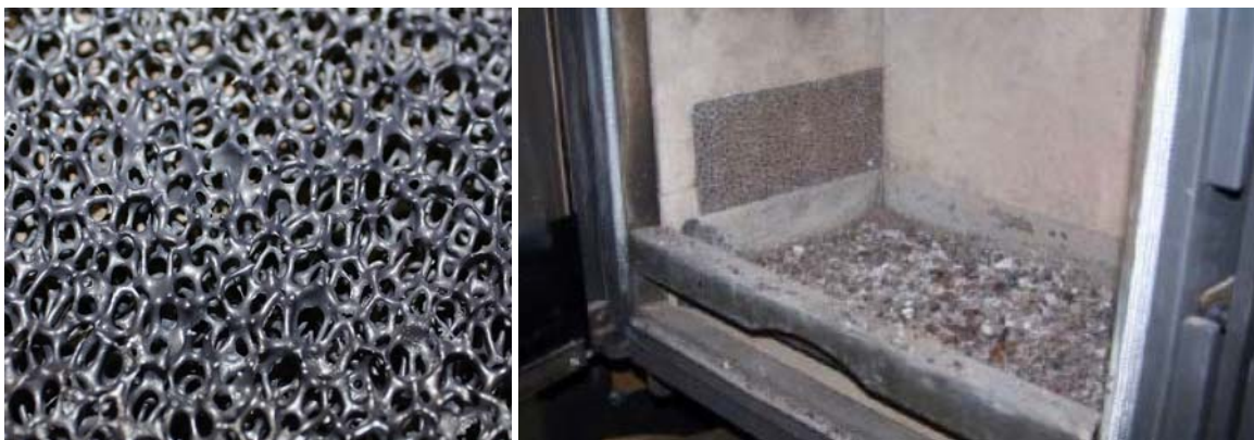
Abbildung 2.39 Oberfläche des ETE-Schwammkeramik-Katalysator (links) und Einbausituation in linke Seitenwand des Kaminofens (Feuerraumausgang) (ETE, 2016 (links) und Bindig et al., 2016 (rechts))
