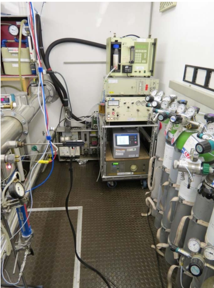
Abbildung 4: Probenahme der gasförmigen Abgaskomponenten (Hintergrund) und Tracergasmessung (Vordergrund)
