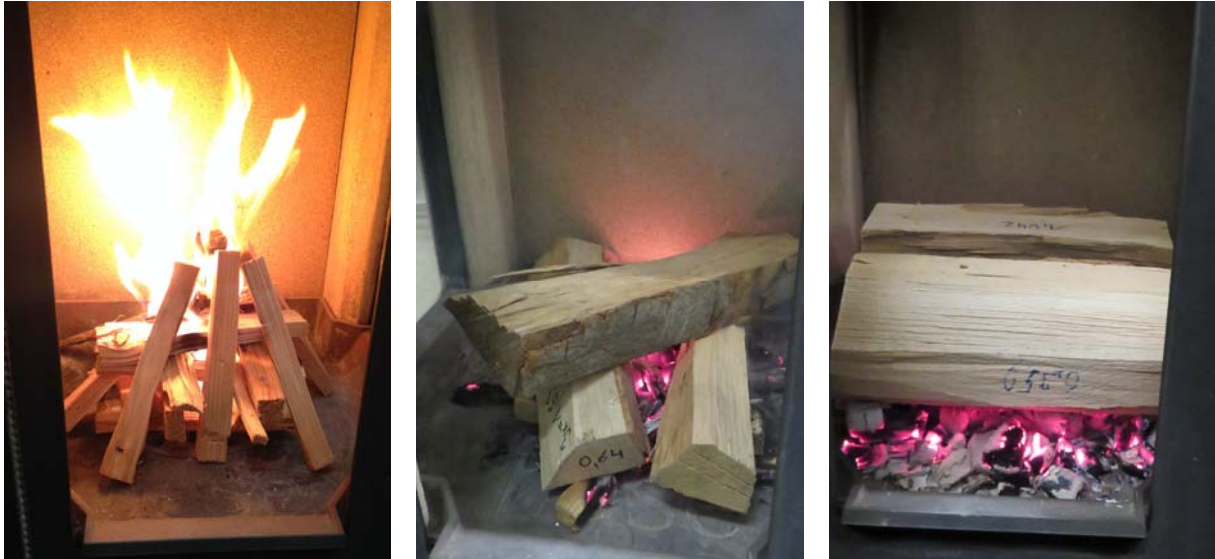
Abbildung 2.9 Anordnung des Holzes im Feuerraum des Kaminofens (links: Anheizen, Mitte: Zwischenabbrand, rechts: Nennwärmeleistung bzw. Normalbetrieb)
