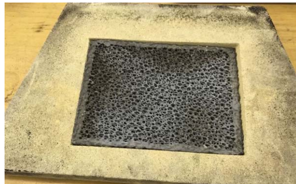
Abbildung 2.47 Katalysator der Fa. Linder (grau) in Umlenkplatte aus Keramik integriert zum Einbau in Kaminofen Typ Copa KK94 der Firma Wodtke GmbH
