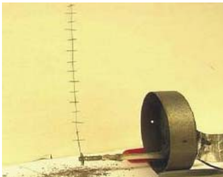
Abbildung 2.7 Entwicklung der Firma Robert Bosch GmbH: Dry ESP für Einzelraumfeuerungsanlagen und Heizkessel (vornehmlich für den Brennstoff Holzpellets) (Mandl, 2010)
