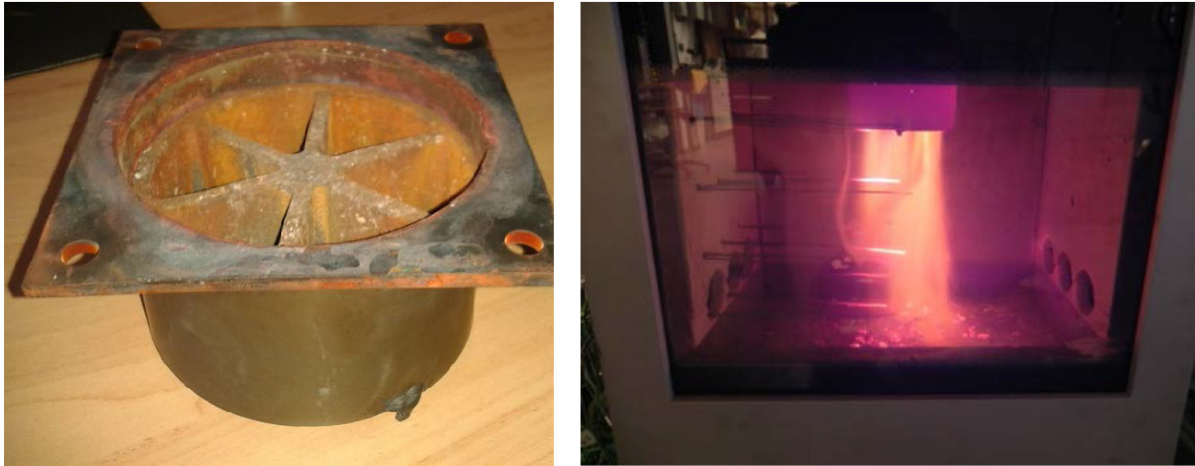
Abbildung 2.40 Rost-Katalysatorelement auf Basis eines \text{MnO}_x/\text{SiC} -Monoliths nach Versuchsende (links) und im Betrieb (rechts) (Bindig et al., 2016)
