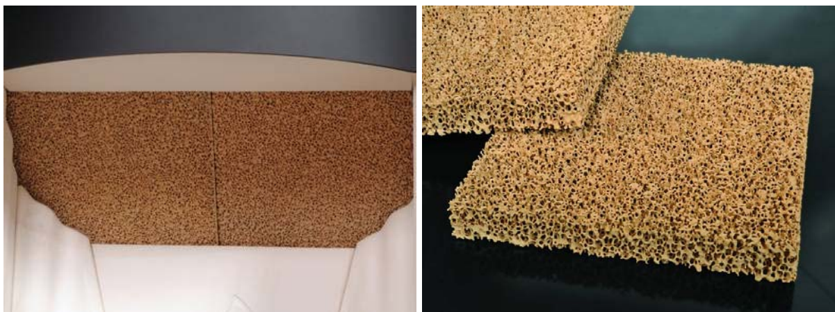
Abbildung 2.42 Schaumkeramikfilter im oberen Bereich des Feuerraums (links) und Oberflächenstruktur der Schaumkeramik (rechts) (Hark, 2017)
