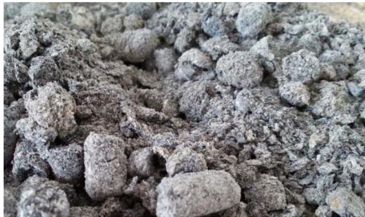
**Abbildung 5.21** Versuchsreihe 6 - Einfluss des Sauerstoffgehalts, Verbrennungsrückstände nach einem Versuch mit Variation der Sauerstoffkonzentration in der Verbrennungsluft während des Abbrandes
