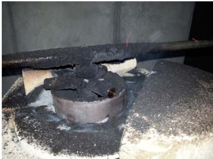
**Abbildung 5.12** Versuchsreihe 5 - Zusatzmodul zur Messung der Scherkräfte, Aschedurchfall durch den Rost nach dem Rührversuch
