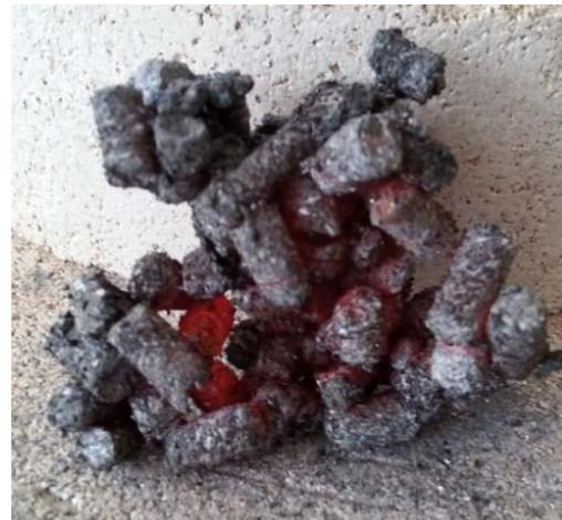
Abbildung 4.9 Inbetriebnahme Laborofen 2 - Ascheschmelze (links) und Agglomerate von Heupellets (rechts)
